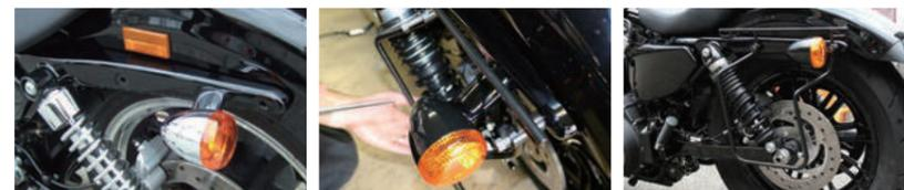
フェンダーストラットのボルトを取り外します。サポートステーを用意し、付属のボルトやカラーを使用してフェンダーストラットの外したボルト穴へ取り付けます。スライドレール併用の場合は、共締めにて取り付けます。
