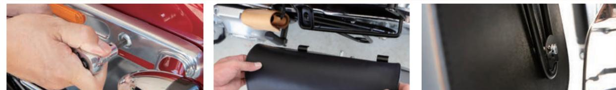
リアフェンダーのボルトを取り外し、ステーを取り付けます。※ステーの取り付け方法については商品に付属している説明書をご参照ください。バッグ側の固定ピンを、車両側ステー下部の穴位置に合わせて調整しながらハンGSTAYを車両側ステーに吊り下げます。Rピンを固定ピンにしっかりと差し込みます。バッグのバタつきや外れることを防止するため定期的にチェックしてください。
