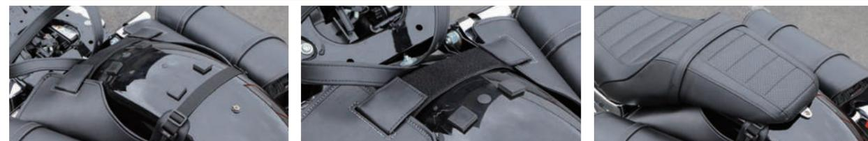
シートを外して、左右のバッグを連結するワタリベルトをリアフェンダーの上に渡します。リアフェンダーの幅に合わせて、ワタリベルトを面ファスナーで調節。車両後方側のリアサポートベルトを調節し、バッグが安定する高さに固定します。シートを取り付け、バッグ背面下部のバタつき防止紐をサポートステー下部にゆとりを持たせて結び、完成です。※バッグサポートステーを併用ください。
