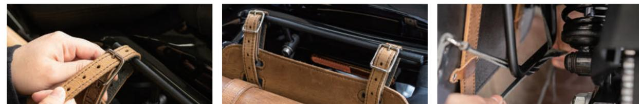
デグナーのサドルバッグは、基本的に付属の取付ベルトで吊り下げて取り付けます。取付ベルトはスライドレールまたは一体型バッグサポートステーにあるベルト用の穴へ通します。スライドレールが取り付けられない車両の場合は、フェンダーストラットへ取付ベルトを通します。吊り下げた後、バッグ背面下部のバタつき防止紐をサポートステー下部にゆとりを持たせて結び、完成です。
